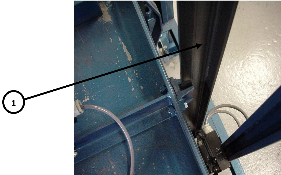
Figure I.3: Les rails de guidage de la cabine [2].
