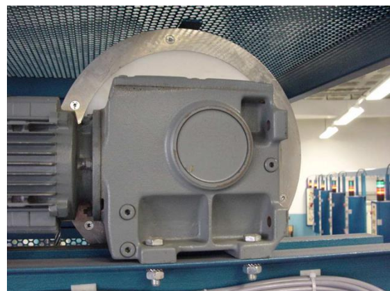
Figure(I.13): Le réducteur à roue [2].
