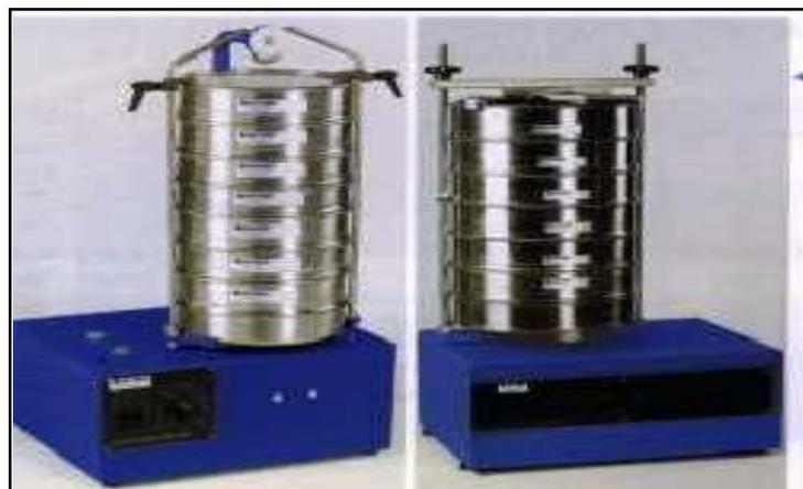
Figure I.9 : Appareil granulométrique.
