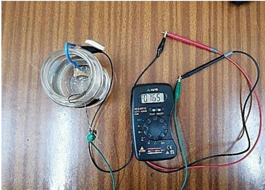
Figure III.7. Dispositif utilisé pour la mesure du potentiel de corrosion de Magnésium dans une solution de NaCl
