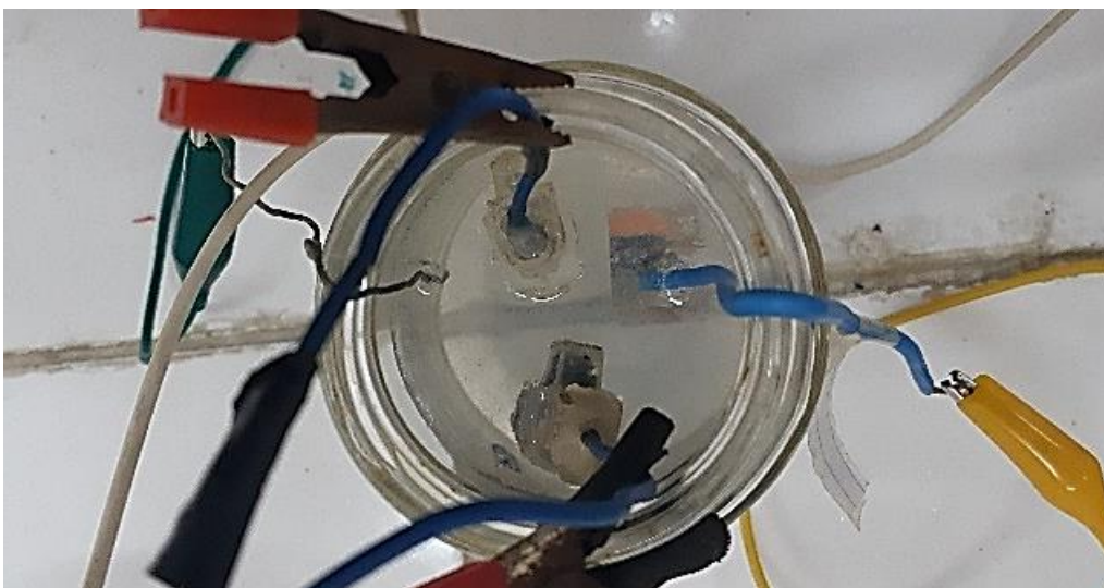
Figure III.9. Dispositif utilisée pour la polarisation dans une solution de NaCl
