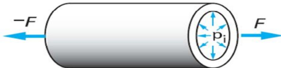
Figure I.28 : Tube à parois minces sollicité en traction-compression
