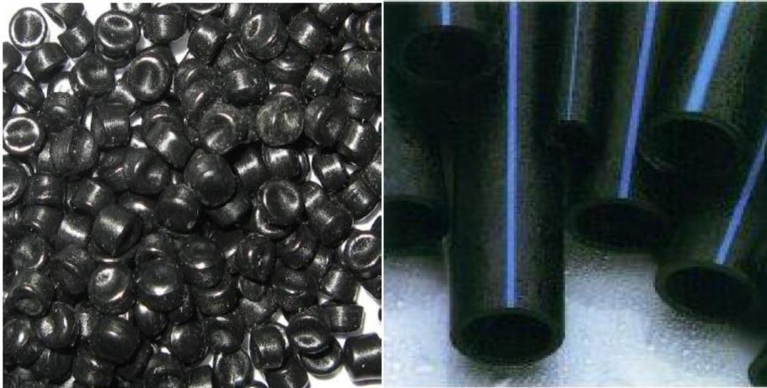
**Figure I.10** : Matière première PE sous forme de granulés et tube PEHD [8]
