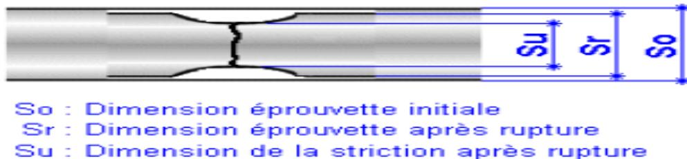
**Figure I.19** : Caractéristiques de l'essai de traction uniaxiale [18]
