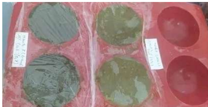
Photo 18 : Aspect de la pâte dans le moule couvert à concentration 10g avec IS 0.1 (Original 2022)
