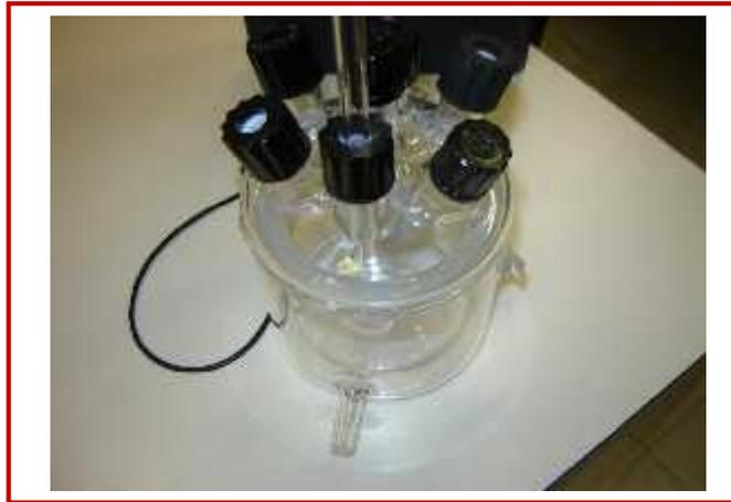
*Figure II.2 : Cellule d'électrolyse*
