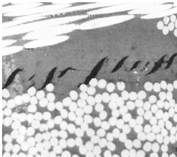
Figure 2 10: Microfissures orientée à  $45^\circ$  du plan de rupture (mode II).
