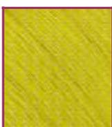
Souvent appelée KEVLAR, la fibre d'aramide est issue de la chimie des polyamides aromatiques. Il est possible de trouver deux types de fibres d'aramide de rigidités différentes:
