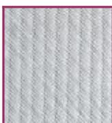
Elles constituent le renfort essentiel des composites de grande diffusion. Elle est obtenue à partir de sable (silice) et d'additifs (alumine, carbonate de chaux, magnésie, oxyde de bore).
