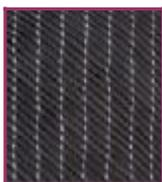
C'est la fibre la plus utilisée dans les applications hautes performances. Elle est issue de la carbonisation de la fibre de PAN (polyacrylonitrile). Selon la température de combustion, on distingue deux types de fibres:
