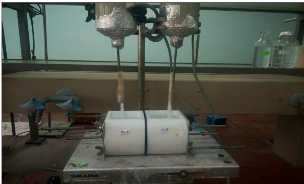
Figure II.6 : Schéma d'une cellule de transport en téflon.
