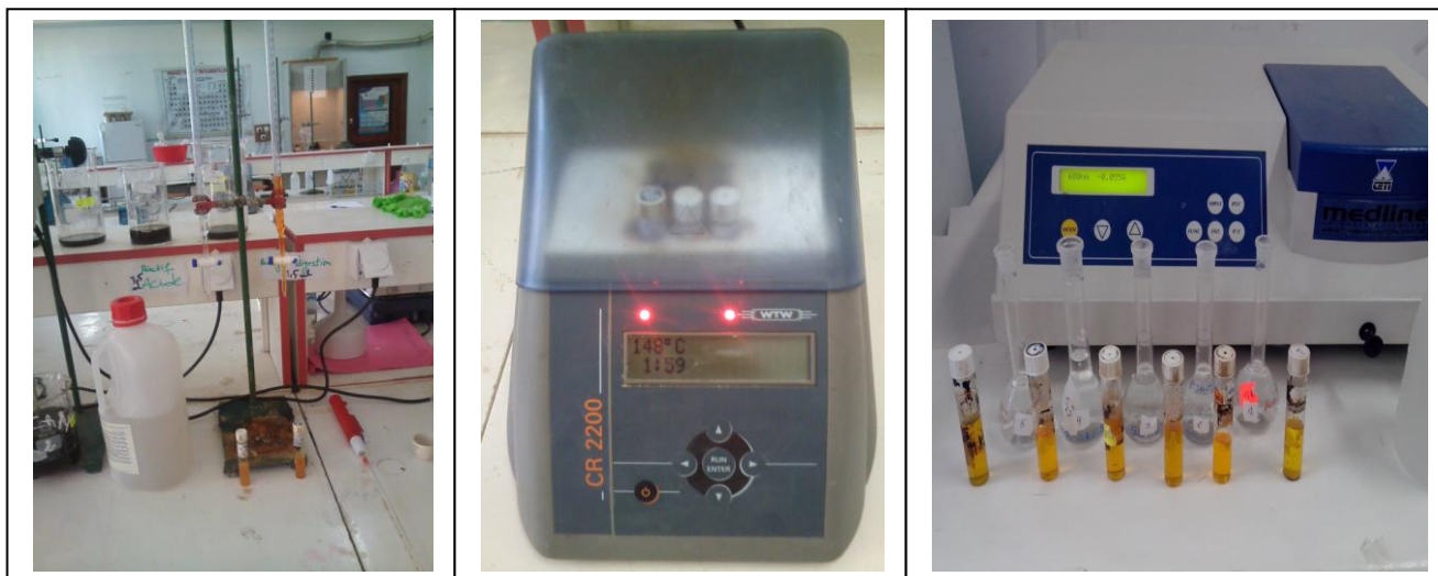
Figure 7 : équipement utilisés lors de dosage de la DCO (Originale, 2015).
