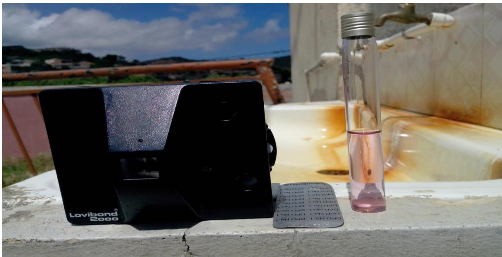
Figure 8 : teste de chlore résiduel libre (originale, 2015).
