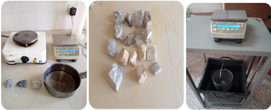
Figure IV.1 – Préparation les échantillons dans le panier de la pesée hydrostatique.
