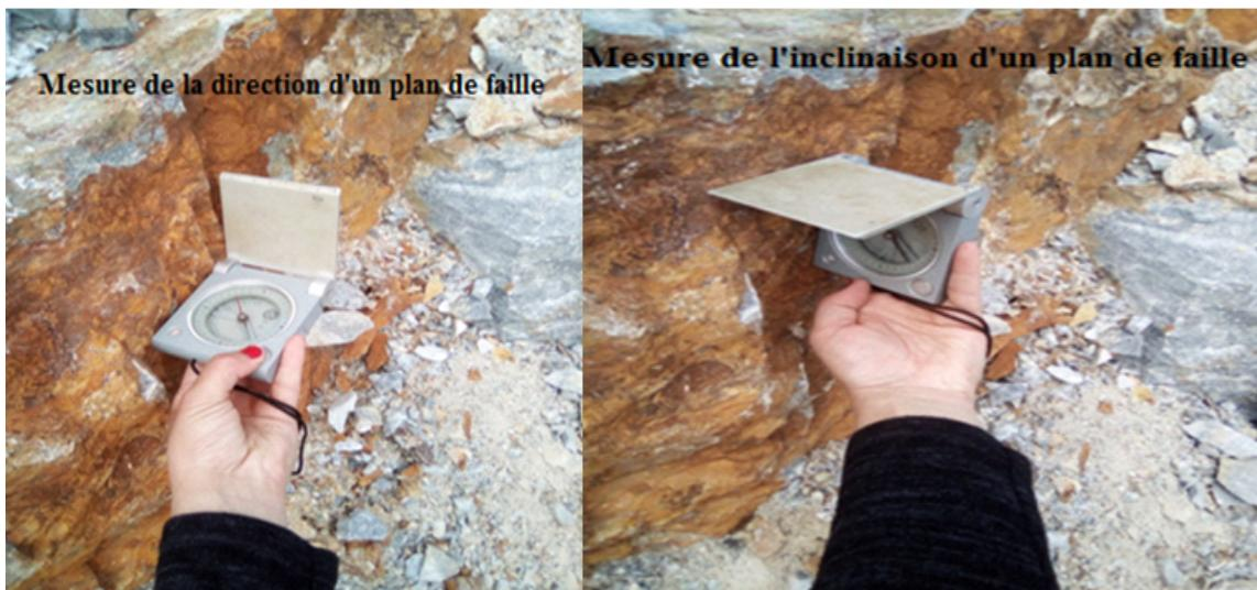
Figure I.12 – Mesures de l'orientation du plan de discontinuité.
