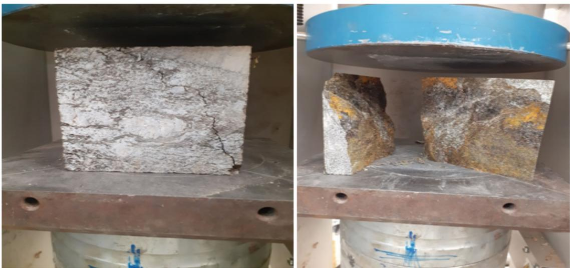
Figure IV.10 – Essai de compression simple sur l'éprouvette cubique de gneiss (laboratoire Béton UMMTO).
