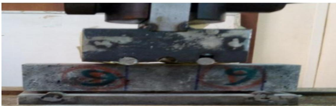
Figure IV.12 – Dispositif pour l'essai de résistance à la flexion (4 points).
