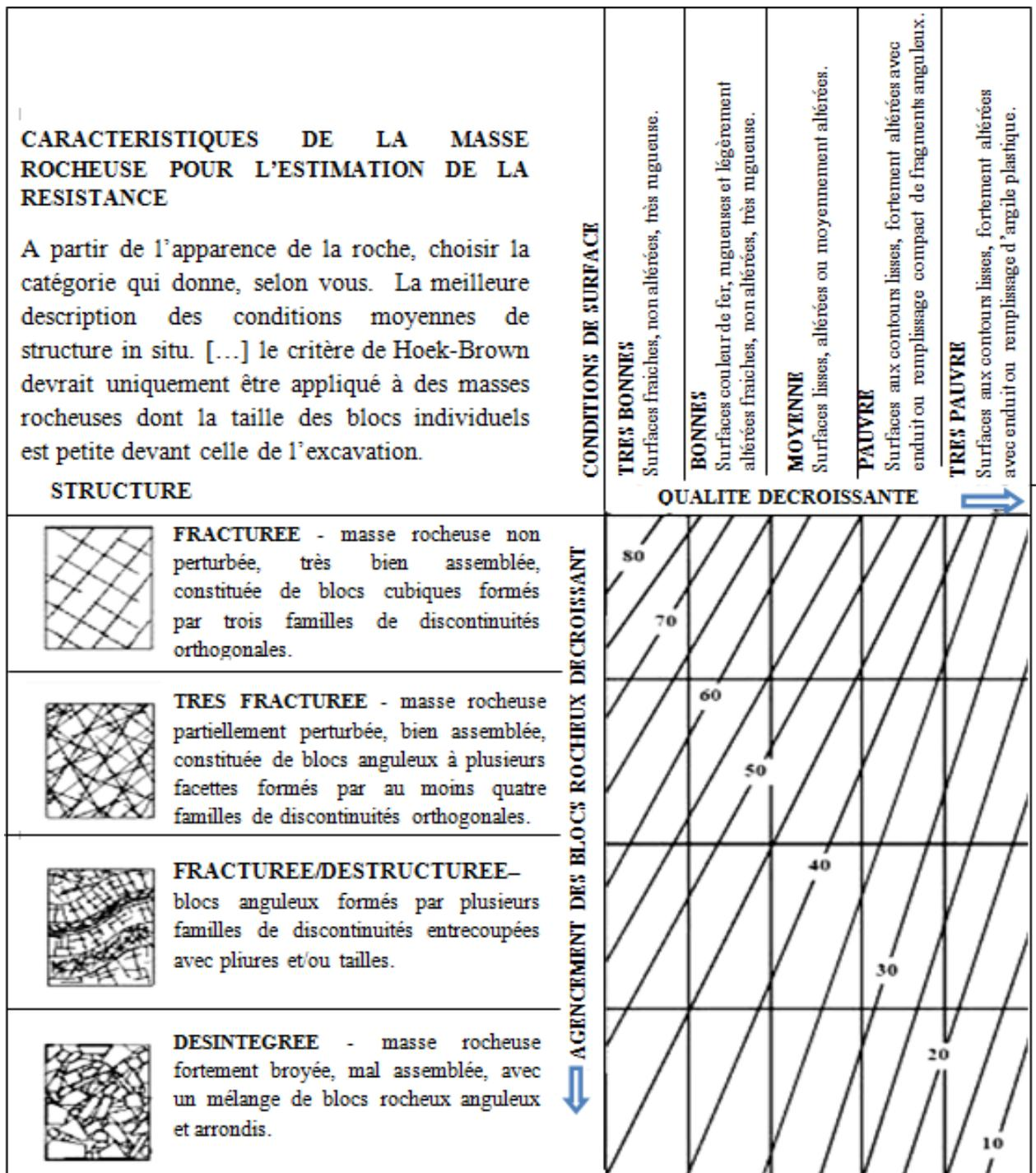
Figure II.2 – Estimation du GSI à partir d'une description géologique de la masse rocheuse (Hoek et Brown, 1995)
