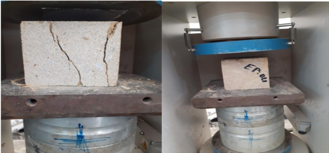
Figure IV.7 – Essai de compression simple sur l'éprouvette cubique de grès (laboratoire Béton UMMTO).
