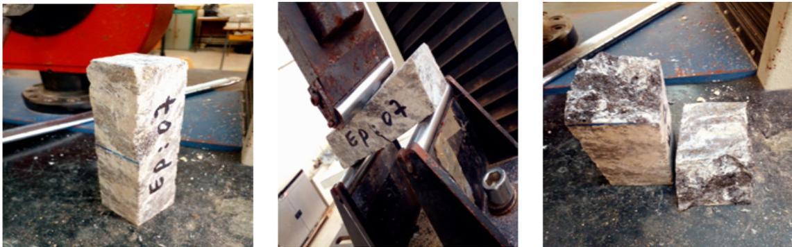
Figure IV.13 – Essai de traction par flexion à trois points sur les roches étudiées.
