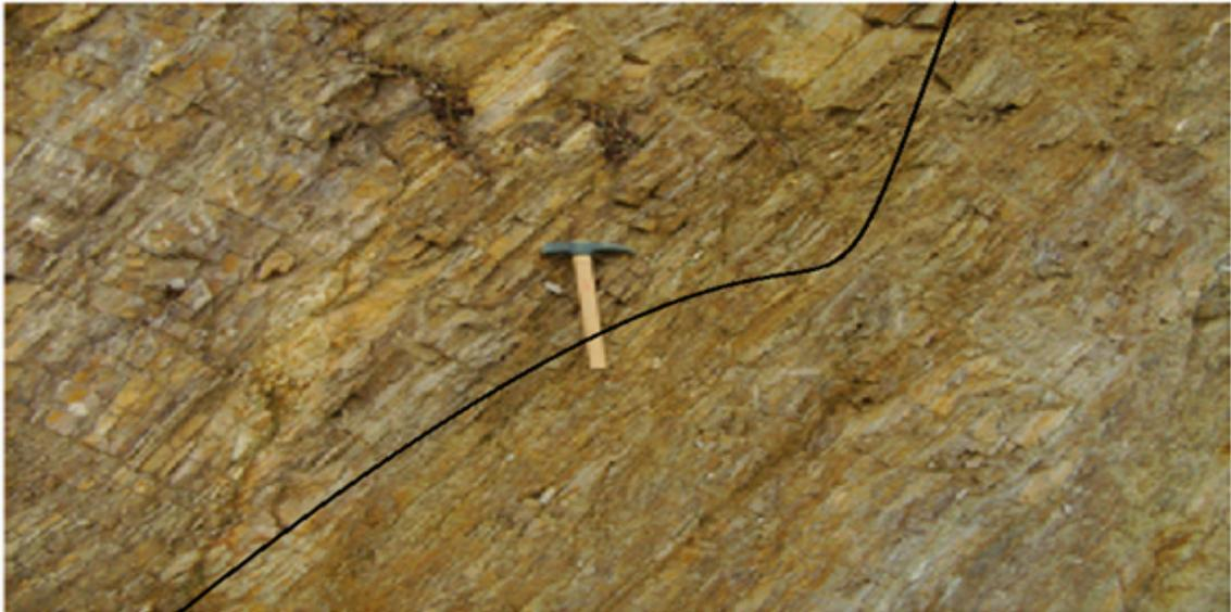
Figure I.9 – Microplissement au niveau des schistes de la région d'étude.
