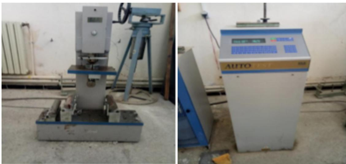
Figure IV.11 – Machine de l'essai de traction par flexion (Laboratoire de Béton UMMTO).
