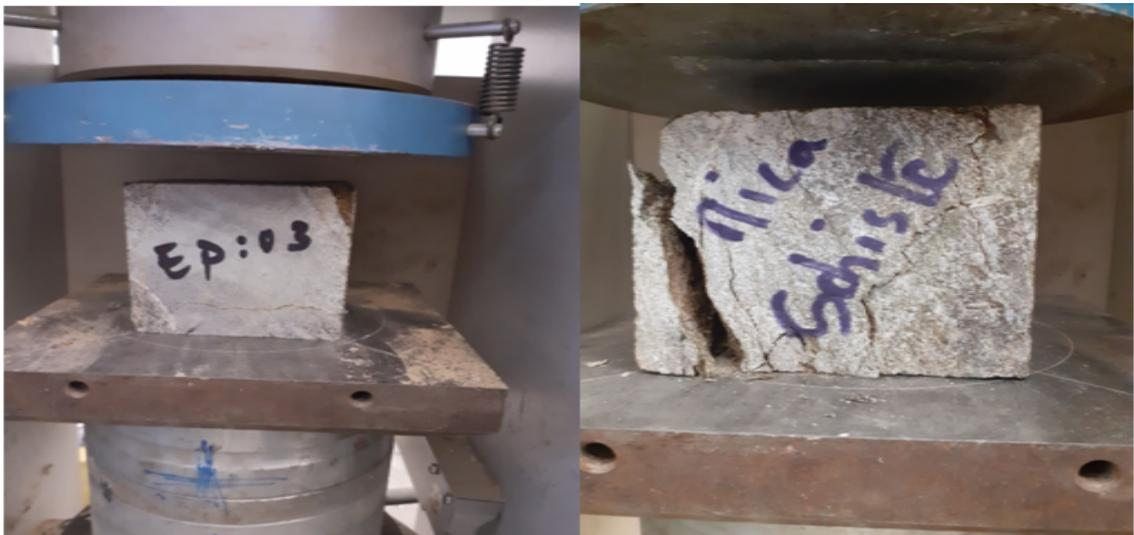
Figure IV.9 – Essai de compression simple sur l'éprouvette cubique de mica-schiste(laboratoire Béton UMMTO).
