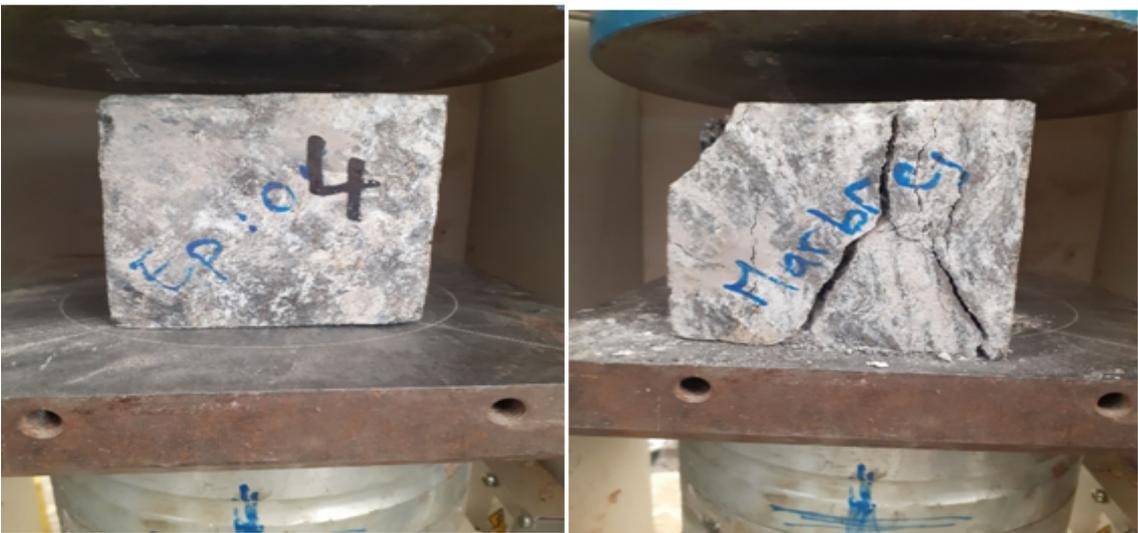
Figure IV.8 – Essai de compression simple sur l'éprouvette cubique de marbre(laboratoire Béton UMMTO).
