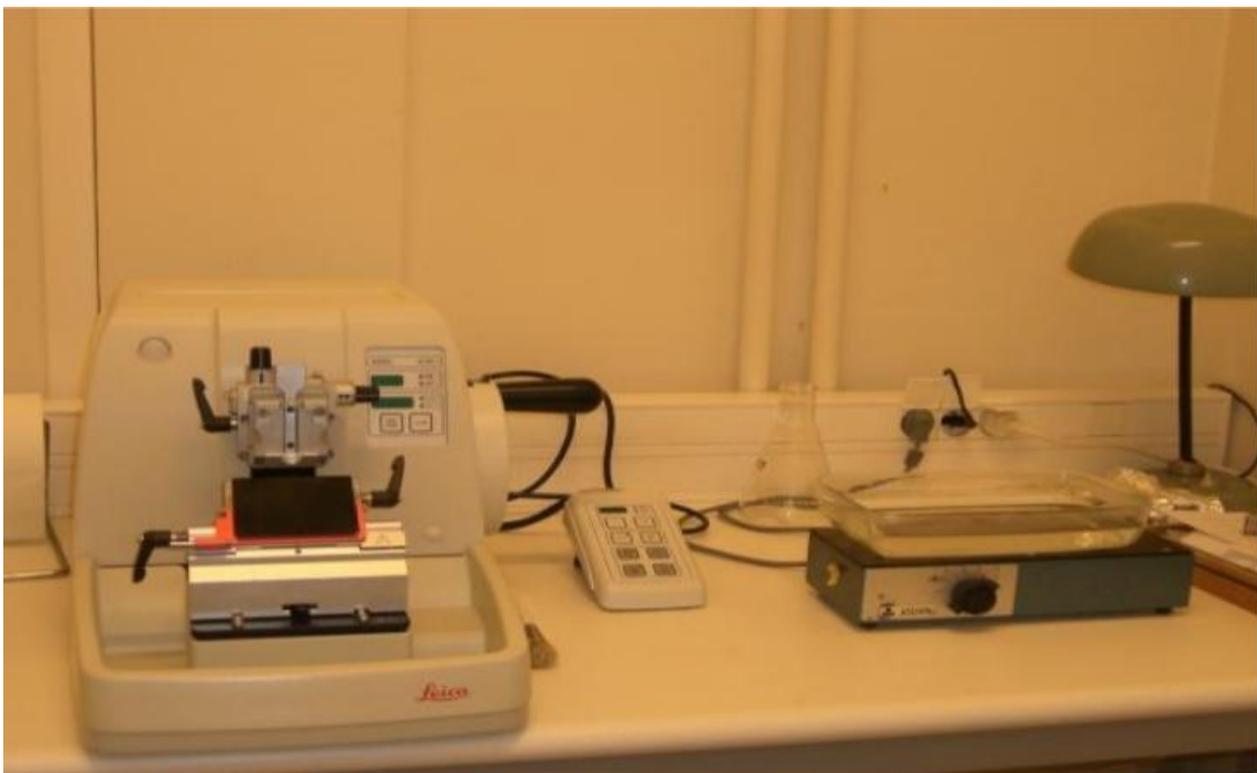
Figure 19: Dispositif permettant de faire des coupes : microtome à gauche et bain Marie à droite (Originale, 2018)
