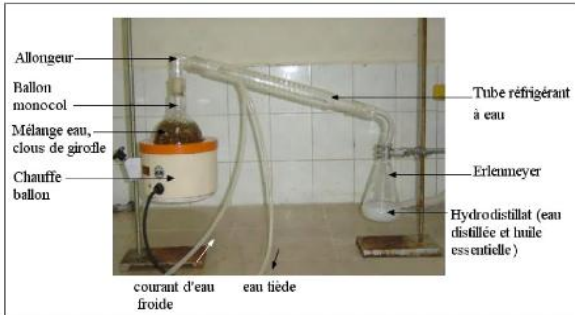
Figure 13 : Extraction des huiles essentielles par entraînement à la vapeur d'eau.
