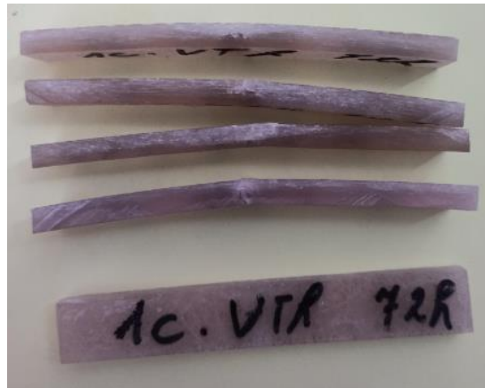
Figure IV.24: Rupture des éprouvettes du monocouche vieilli 72h
