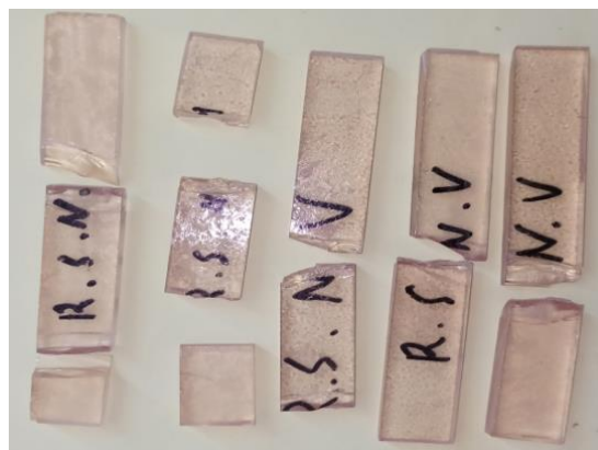
Figure IV.2 : Rupture fragile des éprouvettes de résine
