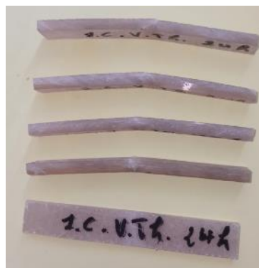
Figure IV.20 : Rupture des éprouvettes du monocouche vieilli 24h
