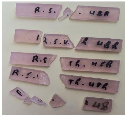
Figure IV.13: Rupture des éprouvettes en résine vieilles 24h
