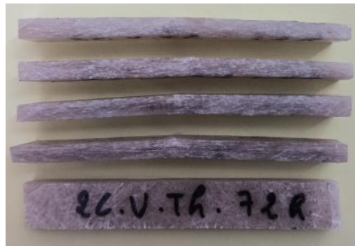
Figure IV.33: Rupture des éprouvettes du bicouches vieilli 72 h
