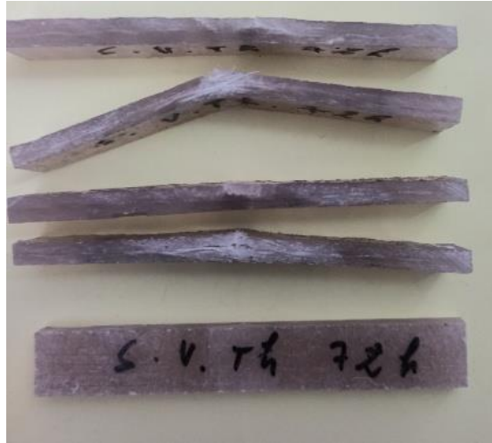
Figure IV.42: Rupture des éprouvettes du tricouches vieilli 72h
