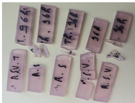
Figure IV.17: Rupture des éprouvettes en résine vieilles 96h
