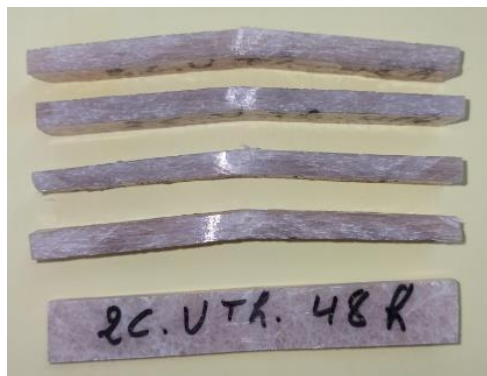
Figure IV.31: Rupture des éprouvettes du bicouches vieilli 48h
