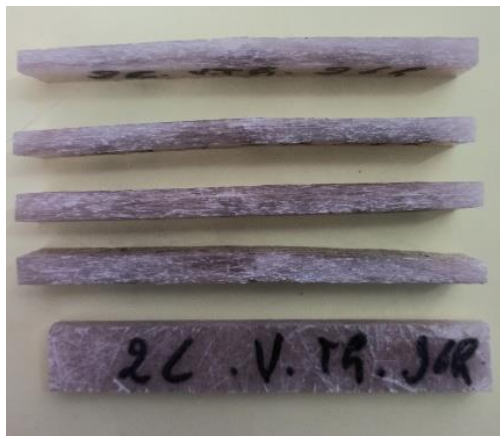
Figure IV.35: Rupture des éprouvettes du bicouches vieilli 96h
