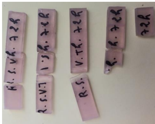
Figure IV.15: Rupture des éprouvettes en résine vieilles 72h
