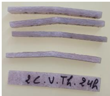
Figure IV.29: Rupture des éprouvettes du bicouches vieilli 24h
