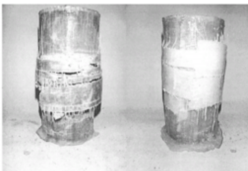
Figure II.17: Mode de rupture des cylindres enveloppés avec fibres de verre
