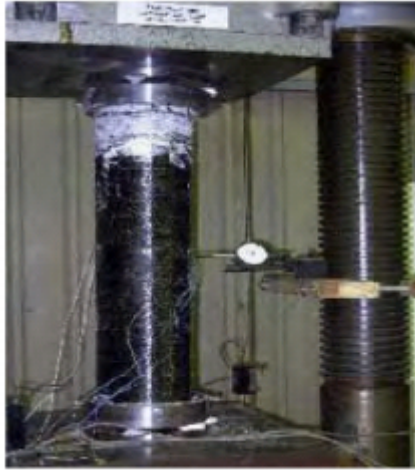
Figure II.28: L'installation expérimentale de colonne confinée par CFRP avec une charge concentrique (Hadi, 2006) [69].
