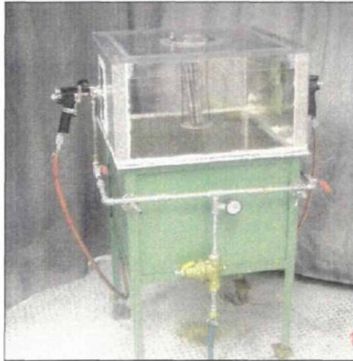
Figure 4 : Gicleurs pour les trempes aux jets d'eau chaude et froide.
