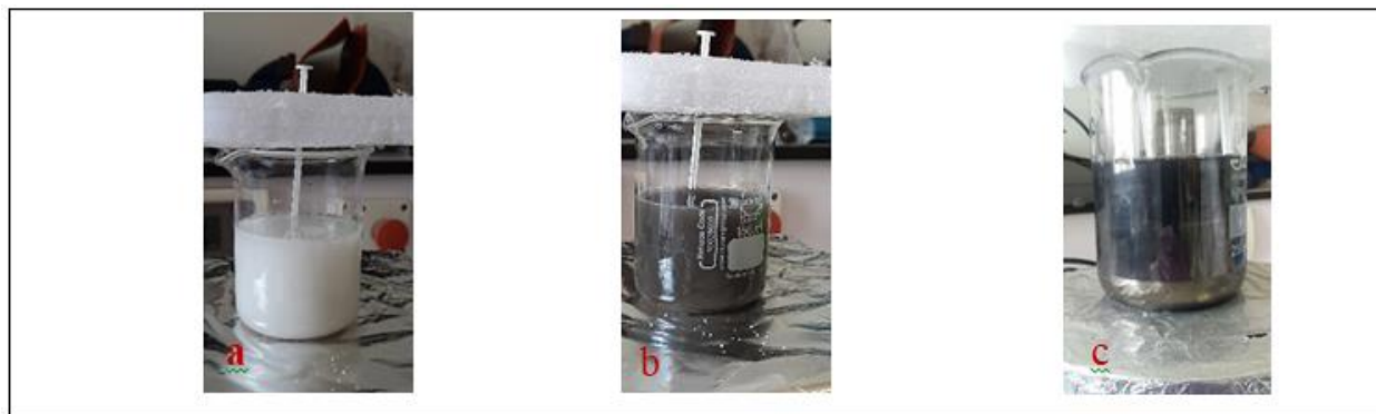
Figure II.9 : Evolution de la réaction (a) avant ;(b) après 6min ;(c) après 16min du dépôt
