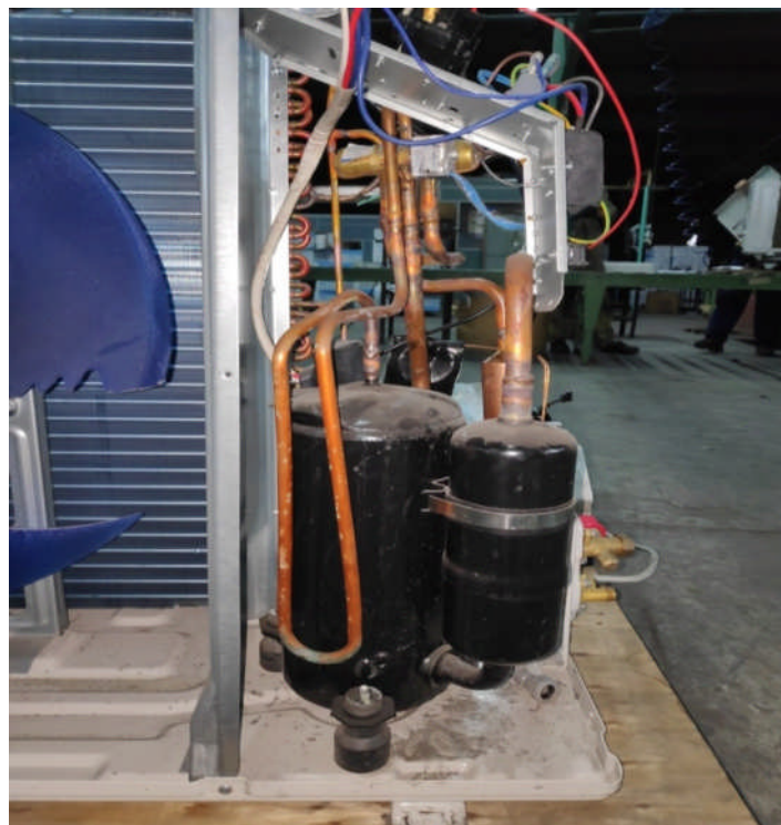
Fig. (III.5) : Compresseur rotatif d'un climatiseur split système.
