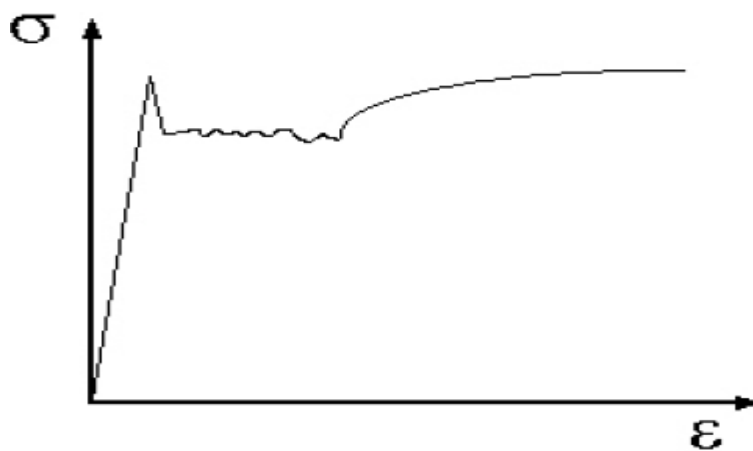
Fig I.8 : Courbe typique de traction avec le palier de Lüders. [2]
