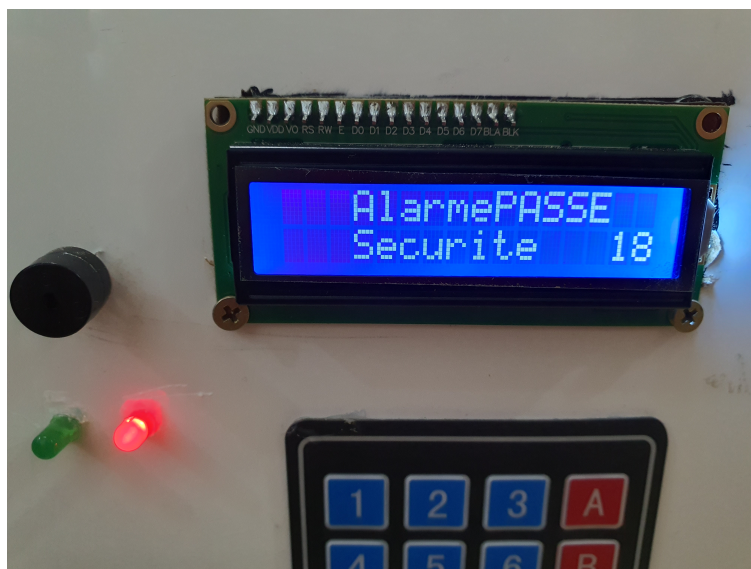
FIGURE 4.9 – ACTIVATION DE L'ALARME.
