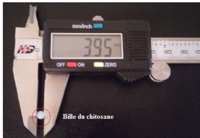
Figure III.23 : Exemple du diamètre d'une bille humide du chitosane déterminé à l'aide d'un pied à coulisse à lecture digitale.
