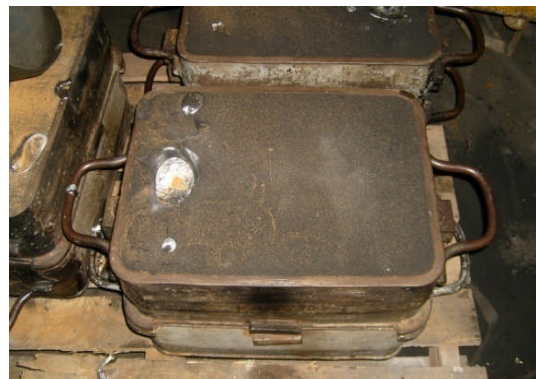
Fig. II.1.5 : Châssis supérieur – Châssis inférieur
