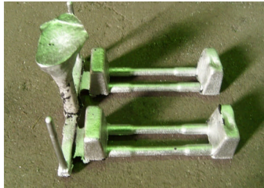
Fig. II.1.11 : Éprouvette en sable
