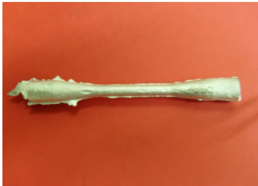
Fig. II.1.10 : Éprouvette en coquille
