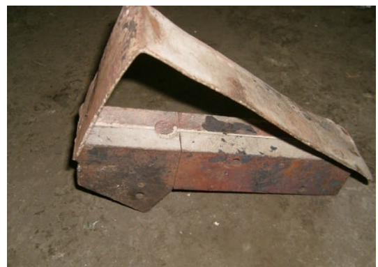
Fig. II.1.9 : moule en coquille métallique
