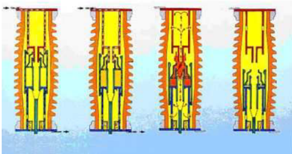
Fig. (III.13) : Principe des disjoncteurs auto pneumatique.
