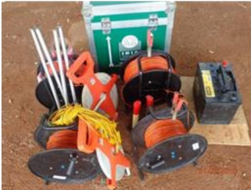
Figure 23 Résistivimètre, câbles et électrodes (matériel utilisé en prospection électrique)
