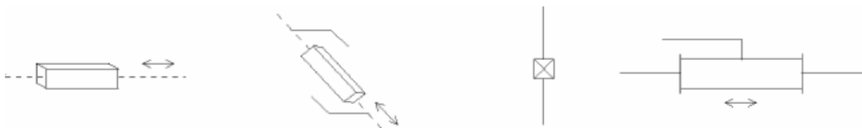
Figure I.5 Symbole de l'articulation prismatique.
