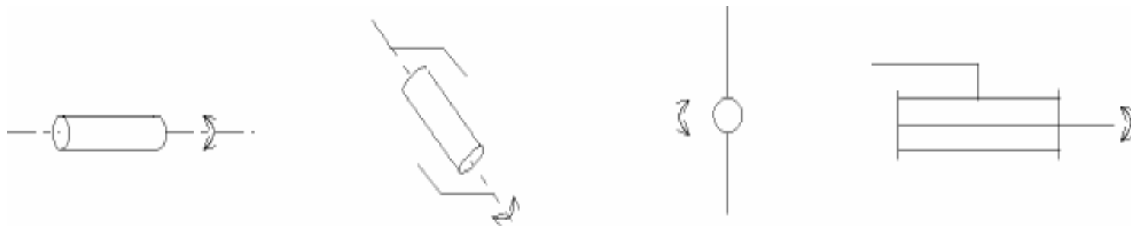
Figure I.4 Symbole de l'articulation rotoïde.
