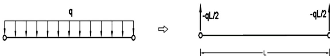
Fig. (II.11) : Cas de poids propre d'une barre d'un treillis.
