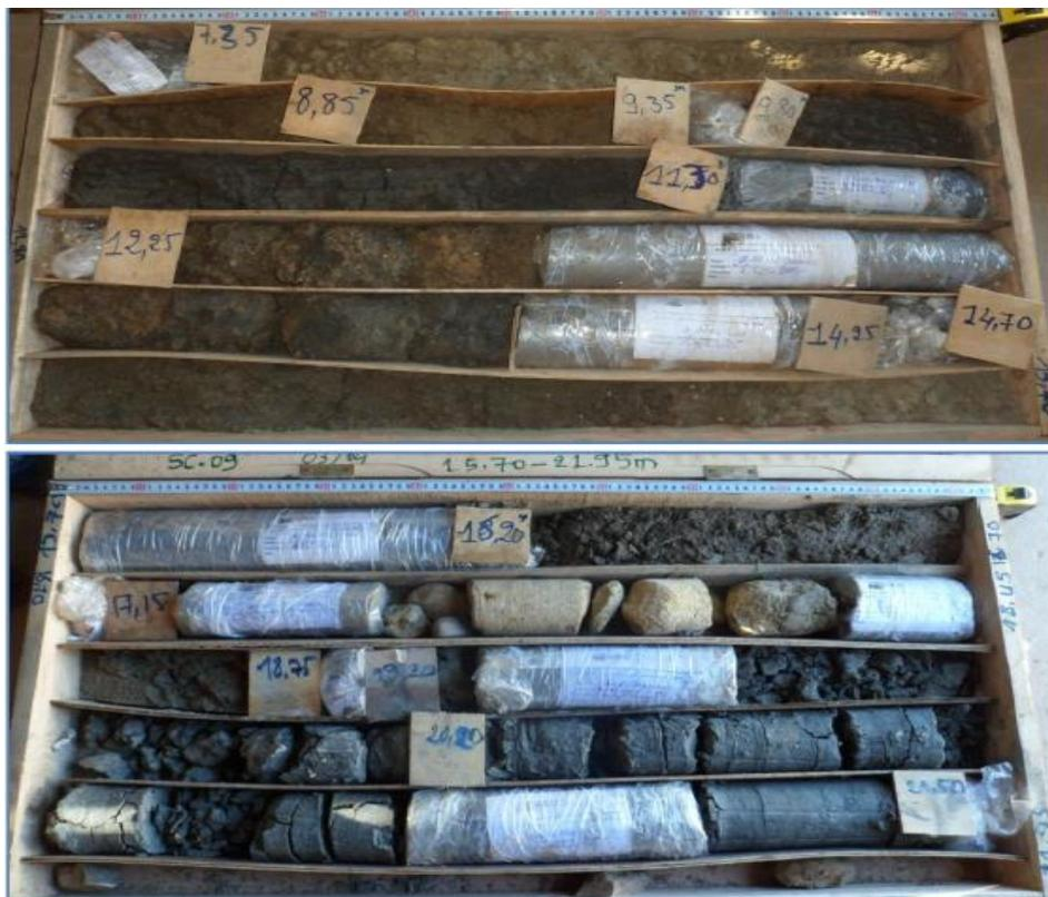
Figure 3-5 : Echantillon d'un sondage carotté prélevé de 7,35a 21,95 m de profondeur
