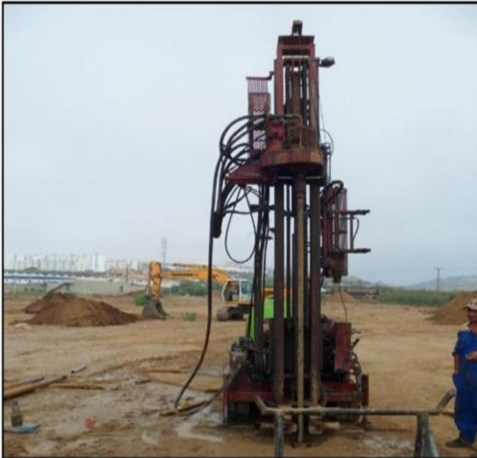
Figure3-4: appareil de sondage et pénétromètre.
