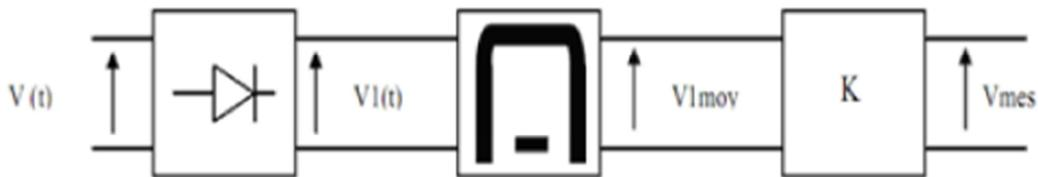
**Figure(II.2) :** Schéma synoptique d'un appareil magnétoélectrique avec redresseur en courant alternatif.
