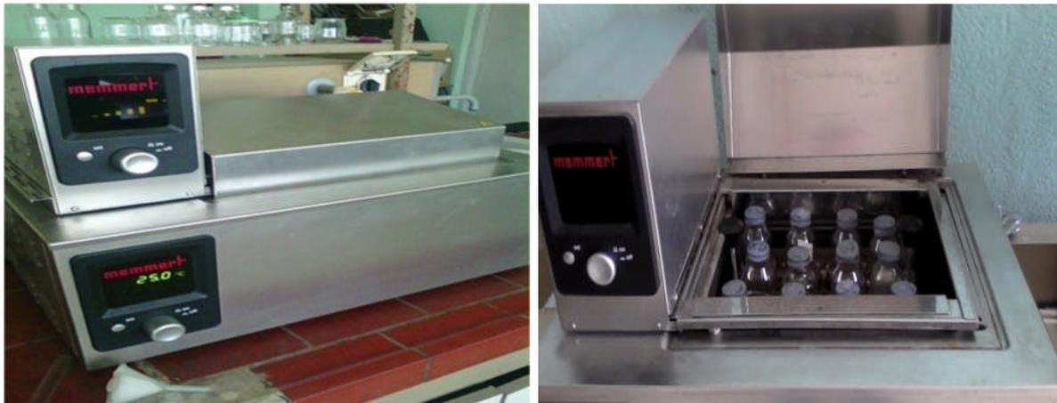
*Figure IV.5 : Dispositif expérimental : agitateur va- et-vient thermostaté*
