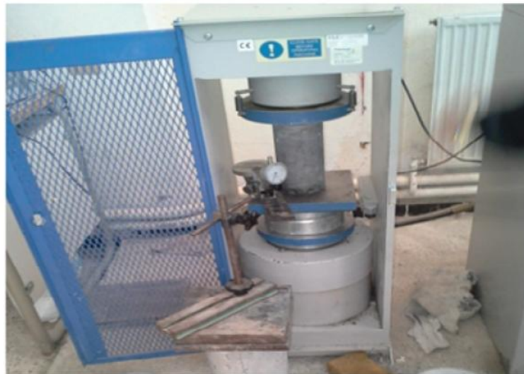
Figure V.5: Presse hydraulique utilisé pour les essais de compression.
