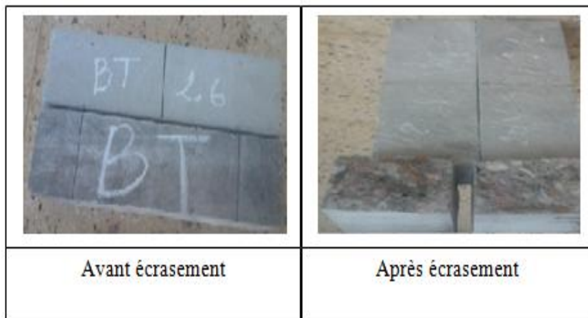
Figure V.13: Éprouvettes avant et après écrasement.
