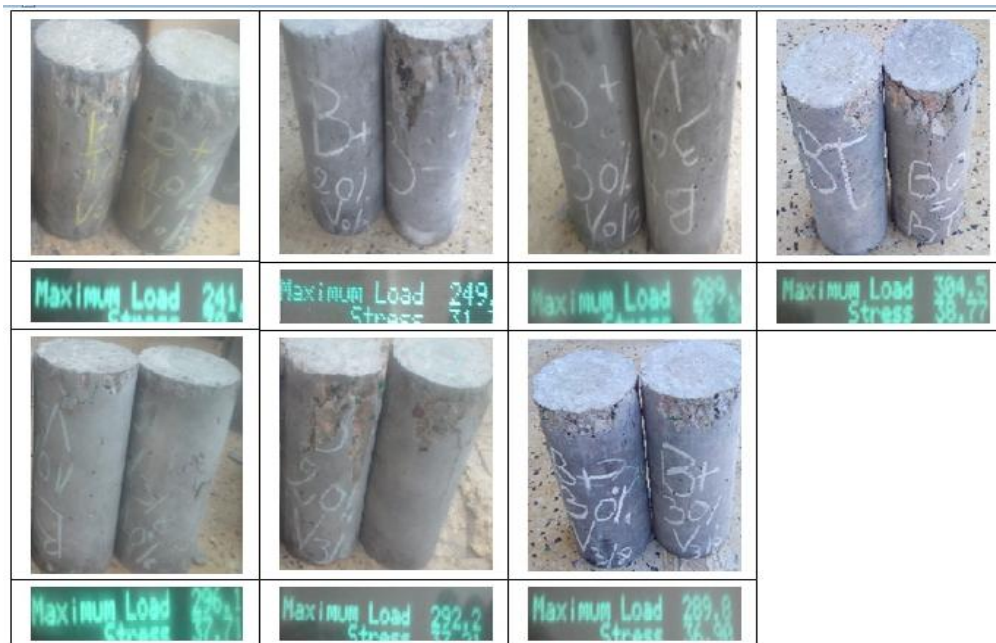
Figure V.6: Éprouvettes après écrasement.
