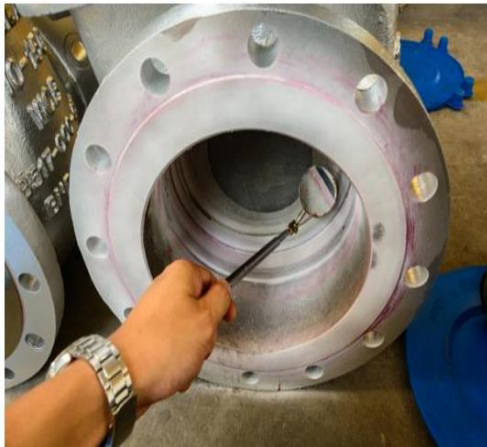
(a) Miroir d'inspection
