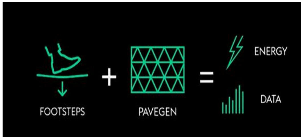
Figure161 : Principe de fonctionnement de Pavegen
