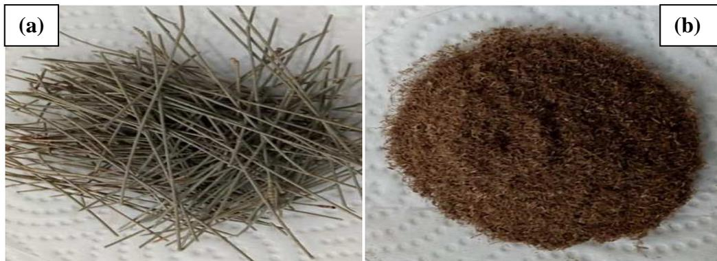
**Figure IV.3** : Feuilles de pin d'Alep : a) avant broyage ; b) après broyage
