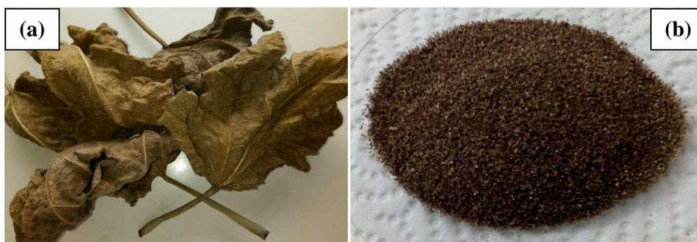
**Figure IV.1** : Feuilles de figuier: a) avant broyage ; b) après broyage
