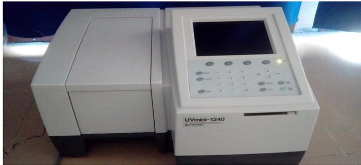
**Photographie d'un Spectrophotomètre UV-Visible (SHIMADZU)**
