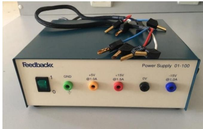
**Figure III. 11:** Photo de l'alimentation du banc
