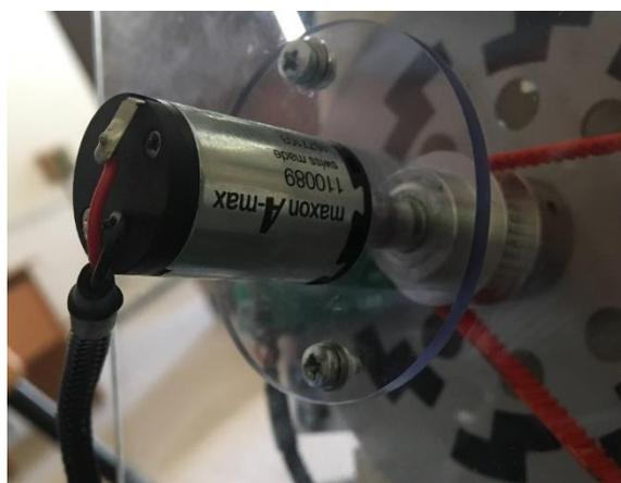
**Figure III. 4** : Photo du tachymètre
