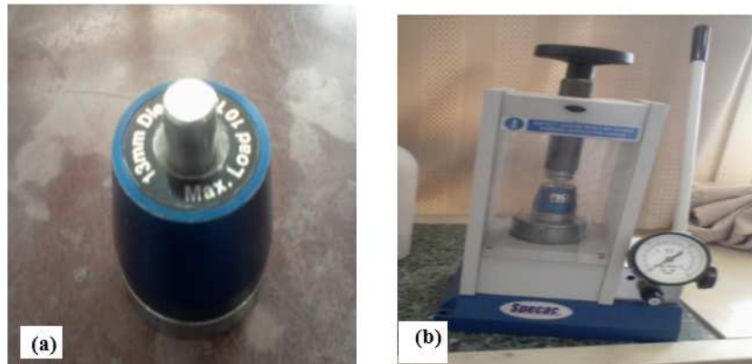
Figure III.4 : (a) Presse à pastiller en acier inoxydable permettant de réaliser des pastilles, (b) l'appareil utilisé pour la formation des pastilles (pastilleuse ou pompe hydraulique).
