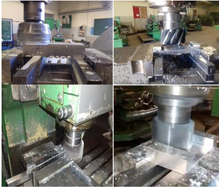
Figure III.11 : les opérations de fraisage.
