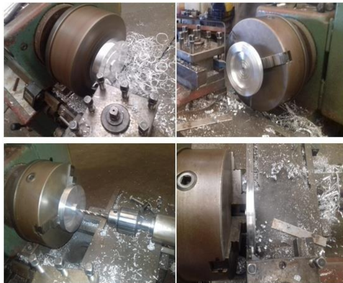
Figure III.12 : les opérations de tournage
