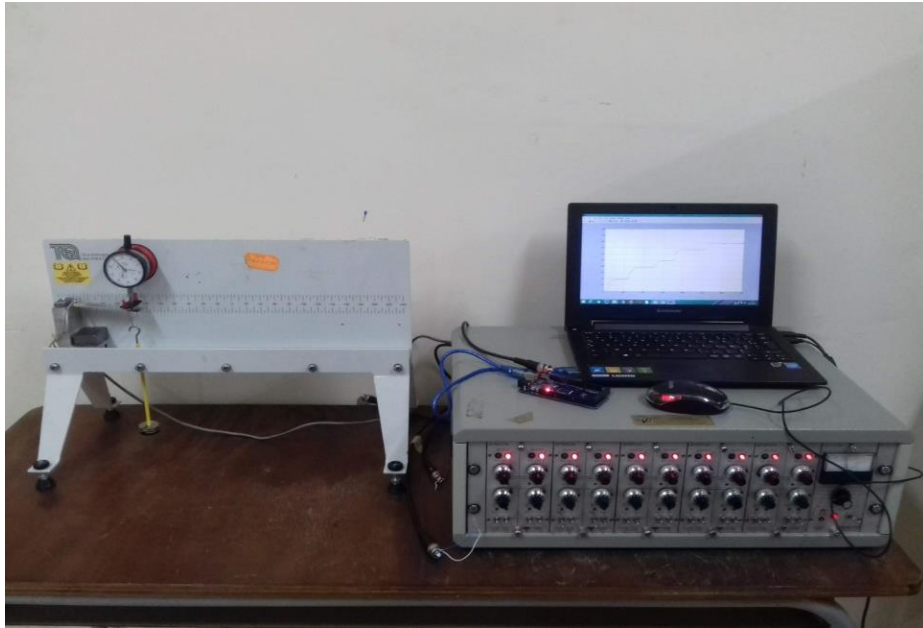
Figure III.22 : Etalonnage de capteur de déplacement.
