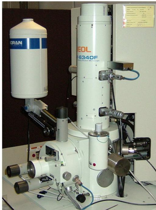
Figure IV.14 : Microscope électronique a Balayage
