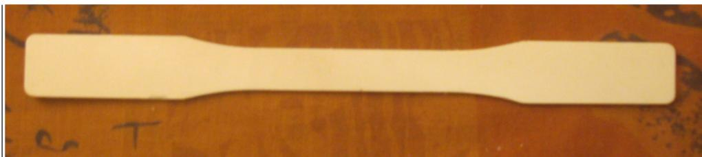
Figure IV.5 : Eprouvettes découpées par poinçonnage pour l'essai de traction.
