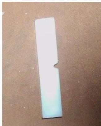
*Figure IV.9 : éprouvette de résilience*
