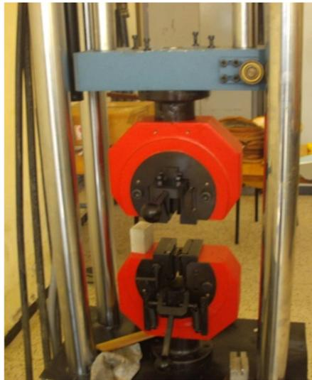
Figure IV.12 : machine de traction
