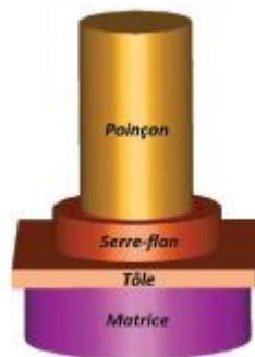
Figure III-1 : poinçonnage d'une tôle
