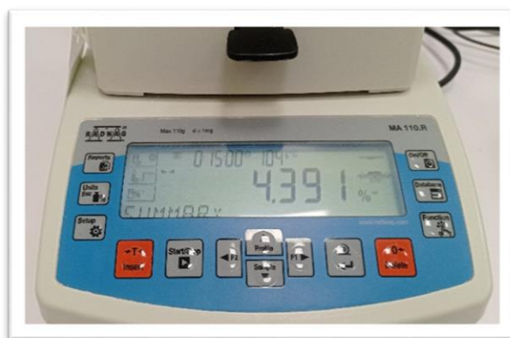
Figure 5: Dessiccateur utilisé pour la détermination du taux d'humidité résiduelle.
