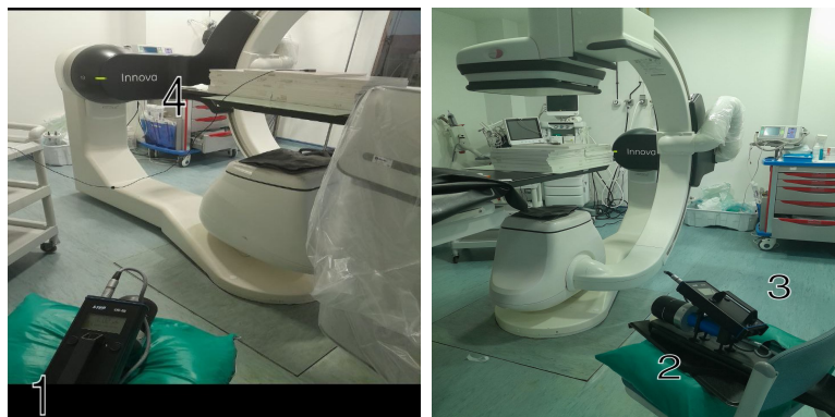
FIGURE 2.18 – Configuration expérimentale des différentes positions de mesure du rayonnement de fuite
