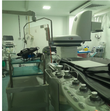
FIGURE 2.19 – Dispositif expérimental pour la mesure du rayonnement diffusé
