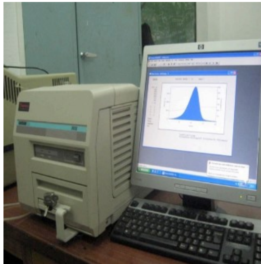
FIGURE 1.11 – Analyse et affichage des données avec lecteur TLD 3500 et l'ordinateur
