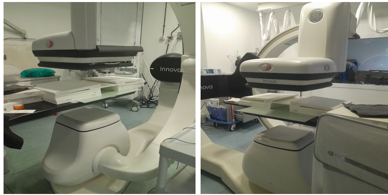
FIGURE 2.17 – Configuration expérimentale pour la mesure du produit dose surface au récepteur d’image
