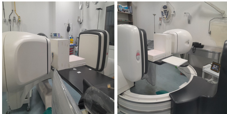
FIGURE 2.14 – Configuration expérimentale pour la mesure du débit de kerma à l'entrée de la surface d'entrée du patient
