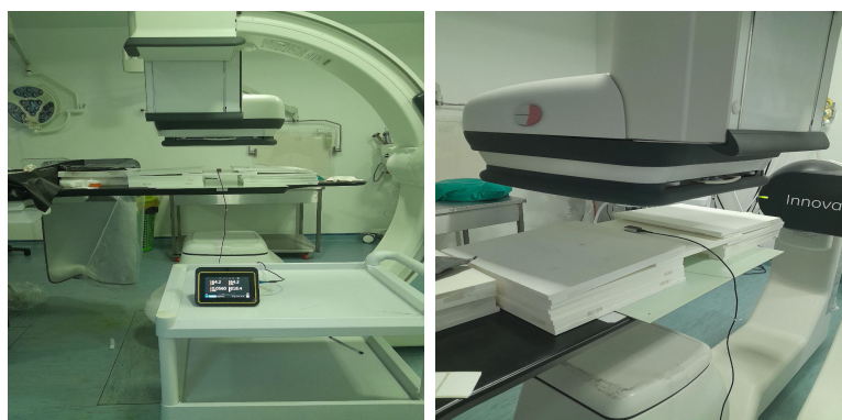
FIGURE 2.16 – Configuration expérimentale pour la mesure du produit dose surface au dosimètre semi-conducteurs
