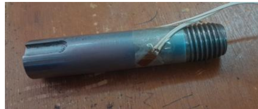
Figure IV 11 : Collage des jauges
