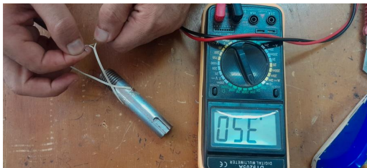
Figure IV 13 : Vérification du bon fonctionnement de la jauge
