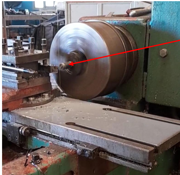
Figure IV 4 : Montage de la barre d'essai dans le mandrin
