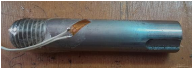
Figure IV 11 : Collage des jauges
