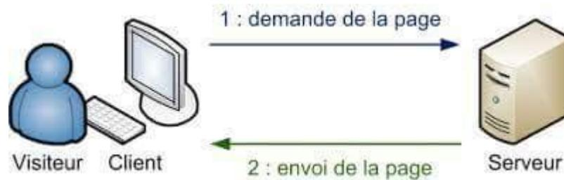
Figure I .5 : Schéma illustratif d'un site web statique.
