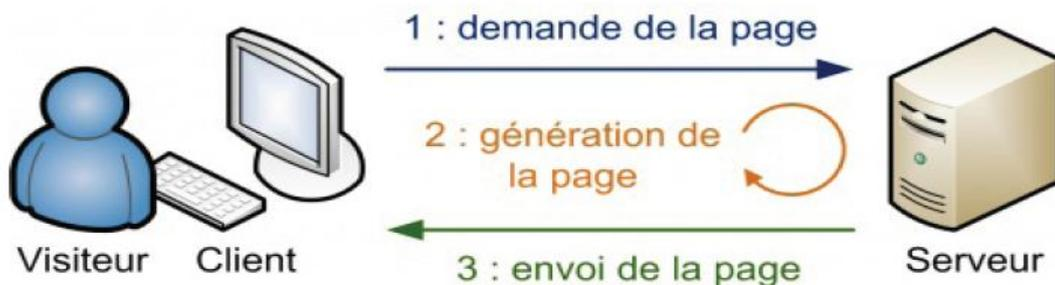
Figure I .6 : Schéma illustratif d'un site web dynamique.
