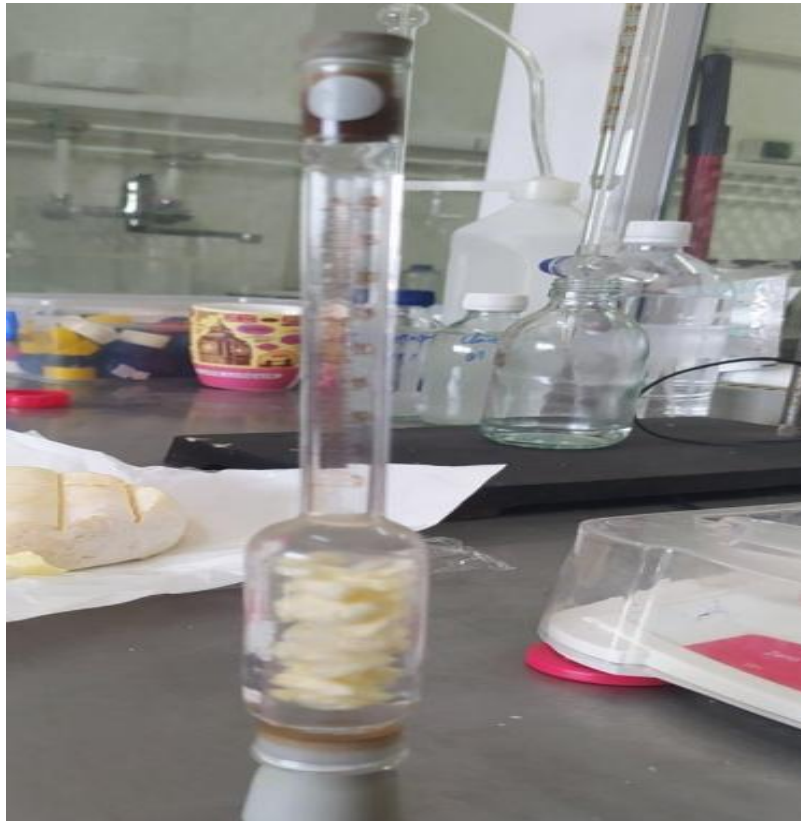
Figure 13 : La mesure de la matière grasse du fromage par la méthode acido-butyrométrique de Van Gulik
