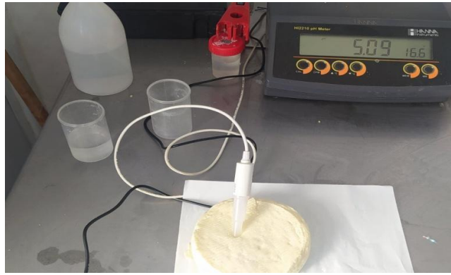
Figure 12 : Le mesurage de ph du fromage par un pH mètre de paillasse
