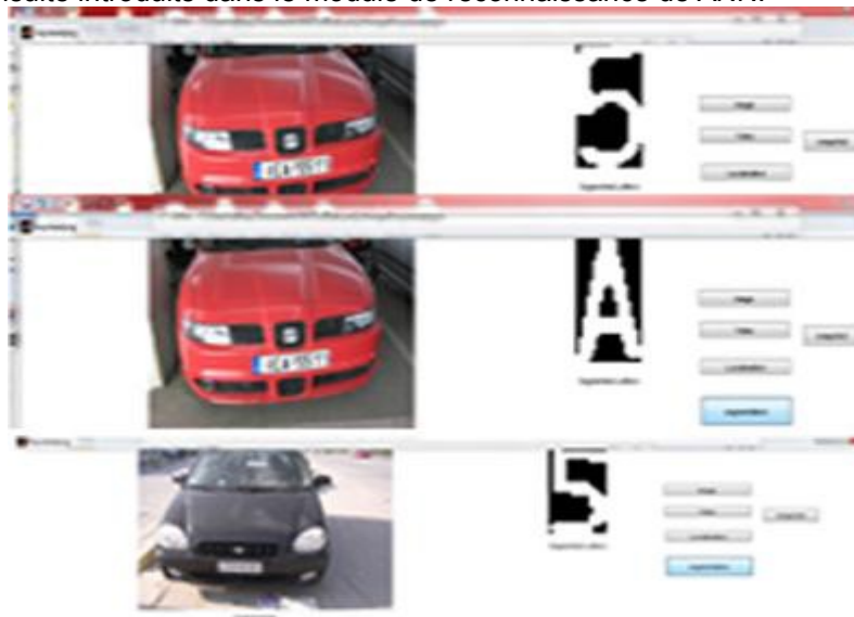
Figure III.5 :la segmentation des caractères en utilisant des opérations morphologiques
