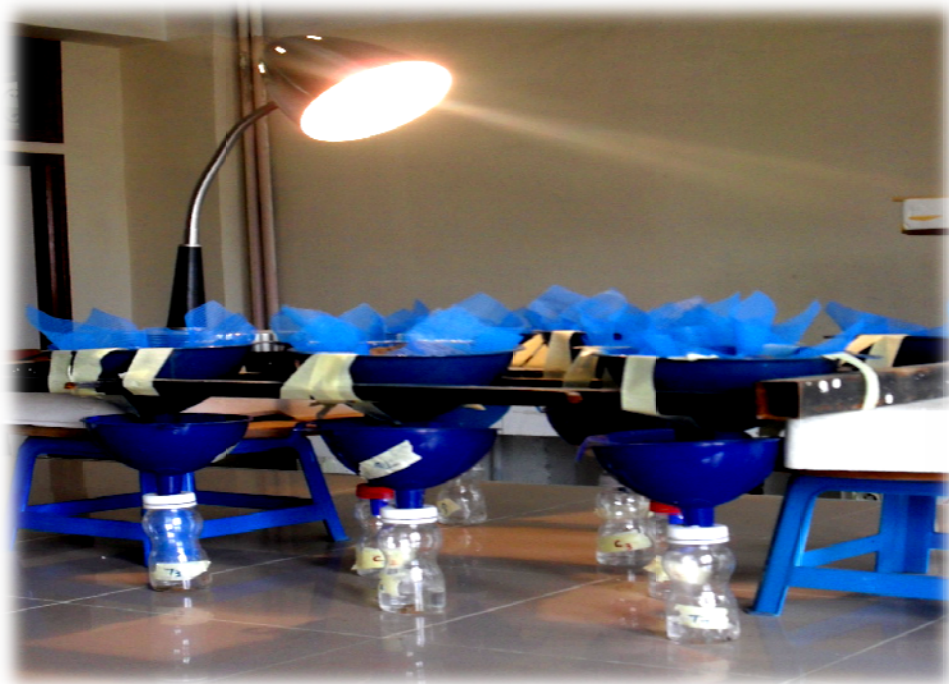
Figure 36: Appareil de Berlese-Tullgren simplifié.
