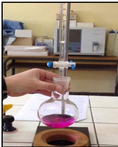
**Figure 21:** Titrage de l'excès de KOH par du HCl
