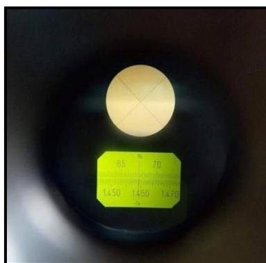
**Figure 42:** Lecture du résultat au réfractomètre
