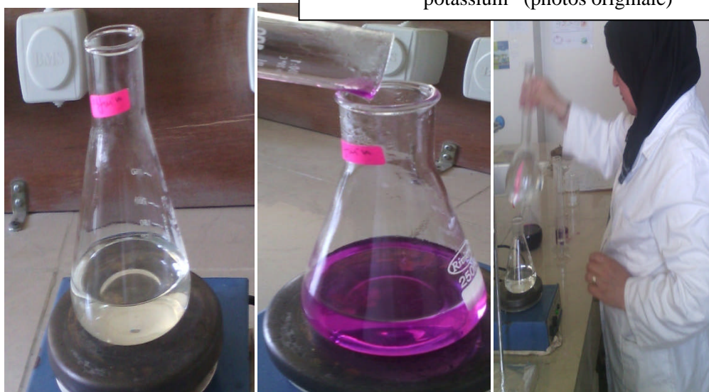
Figure 12 : Etapes de dosage de matière organique par l'Indice IP
