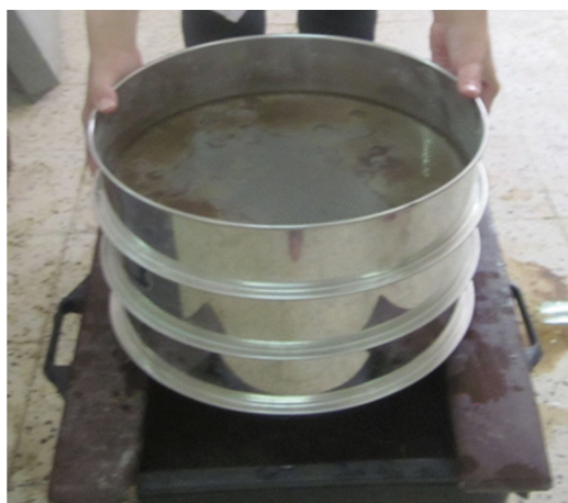
Figure 10 : Passage des échantillons de sol rhizosphérique à travers une batterie de tamis au laboratoire de L G E A (laboratoire de Géométrie, Environnement et Aménagement).
