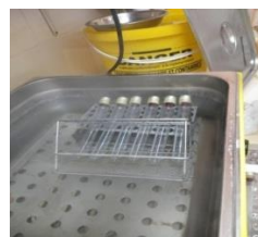
Placer les tubes dans un portoir et mettre au bain Marie
