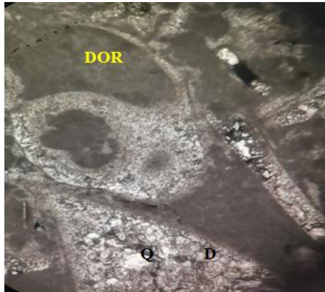
Fig.29 -l'aspect microscopique des débris organique(DOR), dolomie(D), quartz(Q), dans une matrice carbonatée. (Lame mince L.N (G10)).
